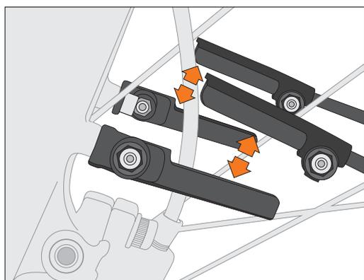
Le système de sécurité Escape (ESC) évite que la roue avant ne se bloque si un corps étranger se coince dans le garde-boue. Cela entraîne le détachement des tringles, qui peuvent ensuite être remises en place.
