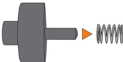
6. **ATTENTION** : Veillez à ce que le système anti-retour soit correctement placé dans l'ancrage prévu à cet effet. Contrôlez la position du ressort !
