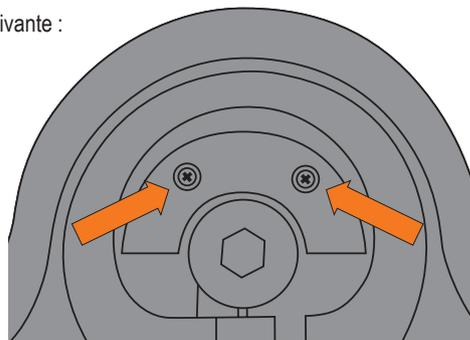
3. Soulevez le couvercle du compartiment à piles et remplacez les piles (2 x 1,5 V AAA). Lors de l'insertion, veillez à respecter les signes plus et moins sur le bord du compartiment à piles. Insérez les piles de manière à ce que le pôle positif du côté positif et le pôle négatif du côté négatif de la pile soient orientés vers le haut.
