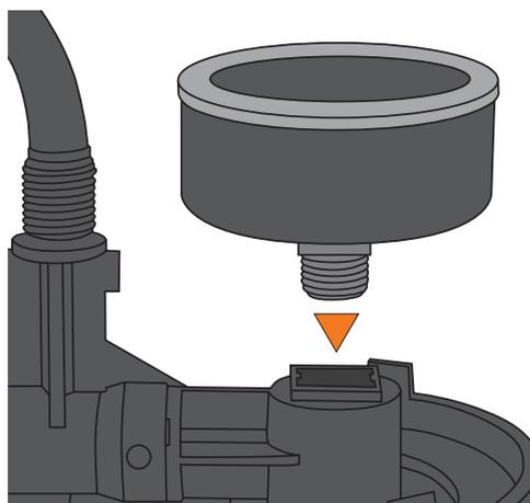
5. Vissez le manomètre avec un couple max. de 2 Nm.
