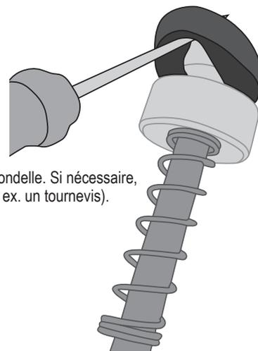
3. Enflez la nouvelle rondelle sur la tige de piston jusqu'à ce qu'elle soit placée dans le joint prévu à cet effet.
