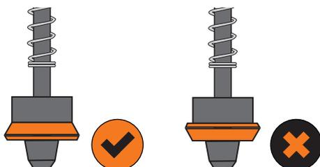
4. Graissez la rondelle en caoutchouc, remettez la tige de piston en place et vissez-la.
