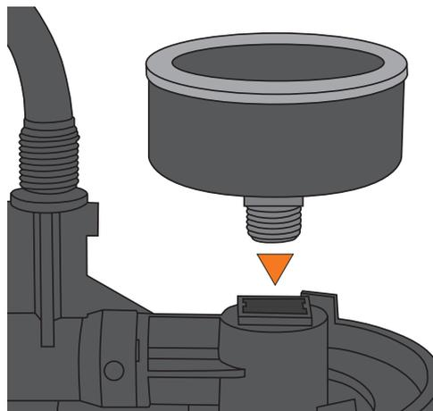
5. Manometer mit max. 2Nm anschrauben.
