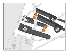
Das Escape-Sicherungssystem (ESC) verhindert ein Blockieren des Vorderrades, sollte sich mal ein Fremdkörper in dem Radschützer verfangen. Die Streben lösen sich in einen solchem Fall und können danach wieder eingesteckt werden.
